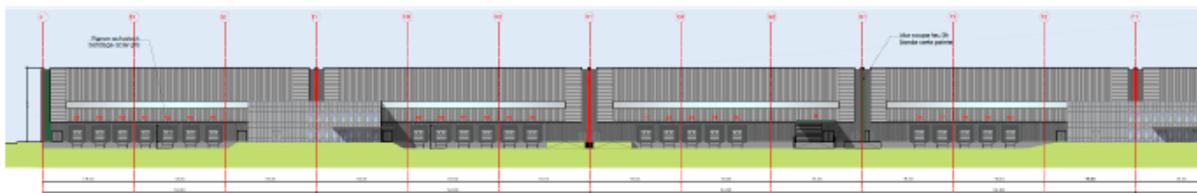
Pour les bureaux, les façades nord/ouest et sud/est par traitées avec des panneaux de bardage plan de teinte aluminium (RAL 9007) sur les faces latérales, le bardage plan encadre un bardage métallique de la même teinte dont l'onde verticale est conforme aux CPAPE.
